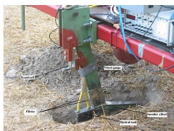
Billede 1. VIS-NIR on-the-go sensoren, der er placeret på et skær, der går 15 cm i jorden.
